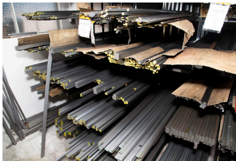
マシンキーの製造は、棒状の材料を切断するところからはじめる。
